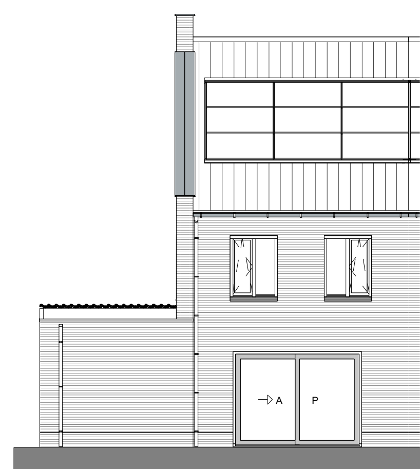
optie: schuifpui in achtergevel
