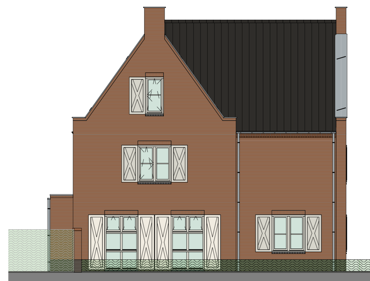
zijgevel links 1 : 100 optie 1: uitbouw 120cm achterzijde woning over de breedte van de keuken optie 2: uitbouw 120cm over de gehele breedte, achterzijde woning
