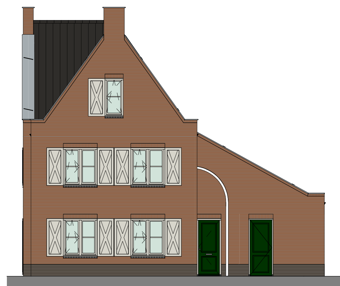
voorgevel 1 : 100 optie 3: berging met enkele deur naar straatzijde
